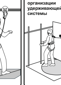
Рис. 12. Способ организации удерживающей системы
