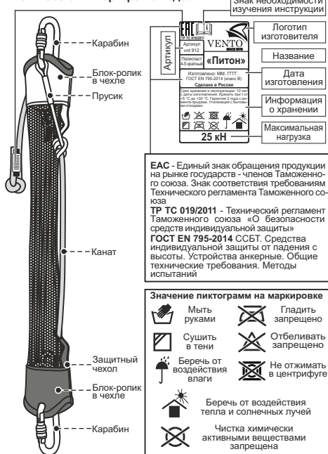
Состав и маркировка карабинов (арт.: vрго 0042)
