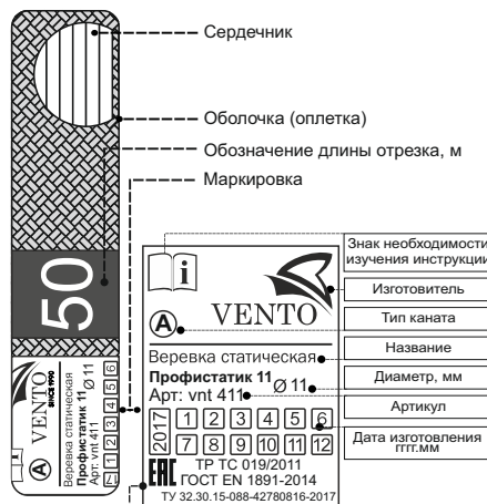
Рис. 1. Составные части и маркировка изделия
