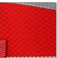
Накладки из композитного материала с влагоотводящей 3D-сеткой
