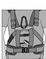
Рис. 9. Правильное крепление соединительного карабина
