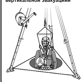
Рис. 14. Способ проведения вертикальной эвакуации
